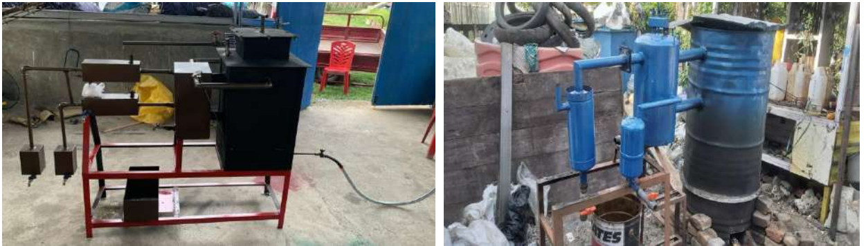
Gambar 9. Replika Alat Pirolisis Sampah Plastik Menjadi BBM
